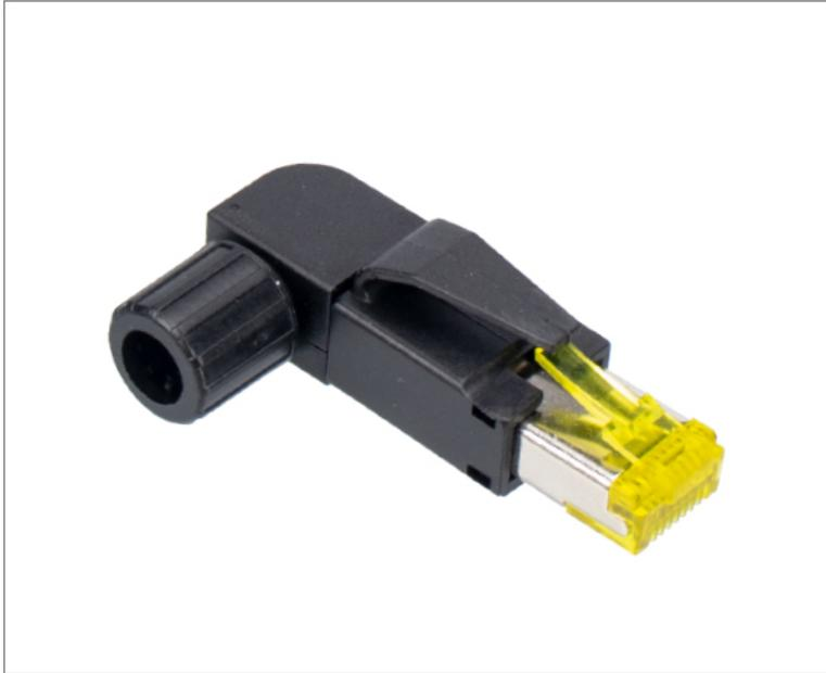
■ 工业RJ45连接器 CAT6A是一种专为工业环境设计的RJ45连接器，适用于Cat6A标准的数据传输，具有更高的数据传输速度和更好的抗干扰能力，适用于要求更高带宽和更稳定数据传输的工业应用，适用于连接网络设备、传输大容量数据信号，对于需要更高带宽和更快数据传输速度的工业控制系统、监控系统等应用场合，具有易于安装和维护的特点，灵活适应不同工业设备之间的连接需求。
